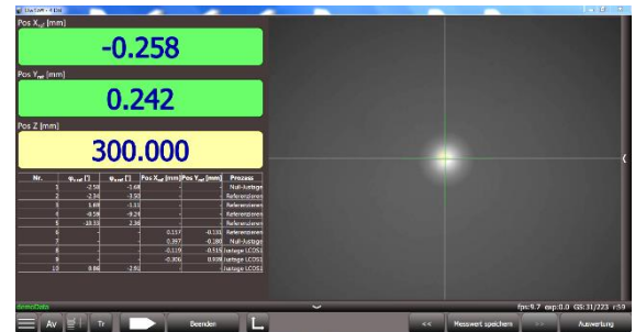
Bild: Positionsmessung mit Tripelreflektor oder Linse
