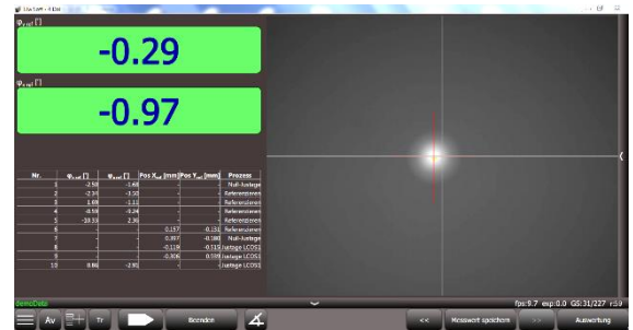
Bild: Winkelmessung mit Planspiegel + Toleranzkreis
