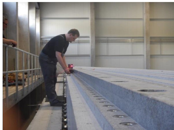
Abb. 1: Linke Wange bestehend aus 4 Granitblöcken á 8 m, links: Messgerät ELWIMAT und Planspiegel auf 500-mm-Messbrücke bei ca. 31 m. Rechts: Mitarbeiter der Fa. Reitz beim schrittweise Positionieren des Messbalkens während der gleichzeitigen Geradheits- (Flucht-) und Ebenheitsmessung. Die Messdauer hier ca. 2 Minuten.
