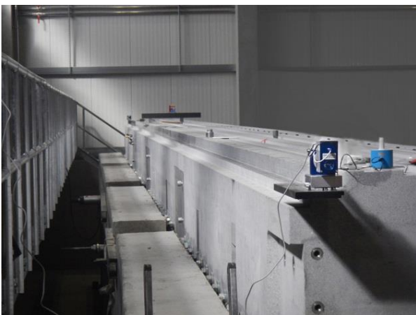
Abb. 1: Linke Wange bestehend aus 4 Granitblöcken á 8 m, links: Messgerät ELWIMAT und Planspiegel auf 500-mm-Messbrücke bei ca. 31 m. Rechts: Mitarbeiter der Fa. Reitz beim schrittweise Positionieren des Messbalkens während der gleichzeitigen Geradheits- (Flucht-) und Ebenheitsmessung. Die Messdauer hier ca. 2 Minuten.
