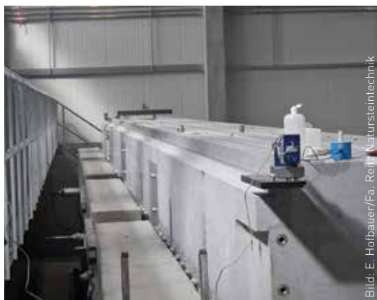
Linke Wange der Maschine bestehend aus 4 Granitblöcken mit je 8 m Länge. Das neue Geradheits-Messgerät im Vordergrund rechts, Messbasis mit 80 mm Spiegel in circa 30 m Entfernung.
